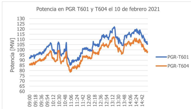
Figura No.3: Registro de potencias transferidas por transformadores de El Progreso
